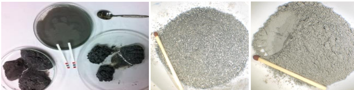
Figur 5. Tre glasskåler med beinasken til tørking i varmeskap. Grov (midtbilde) og fin beinasken («facing») etter knusing og sikting av tørket materiale.
